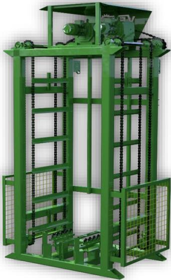
AVEC L'AIDE DU CHARIOT ELEVATEUR ET D'APPAREILS FIXES SUR LE CHARIOT. LES PALETTES VIDES OU LES PRODUITS SE TROUVANT SUR L'APPAREIL DE CHARIOT SONT PLACES SUR LE DESCENSEUR.
